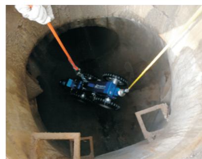
以中间挂钩为主要承力绳，尾部电缆调整方向，防止磕碰，到达底部前调平车身
