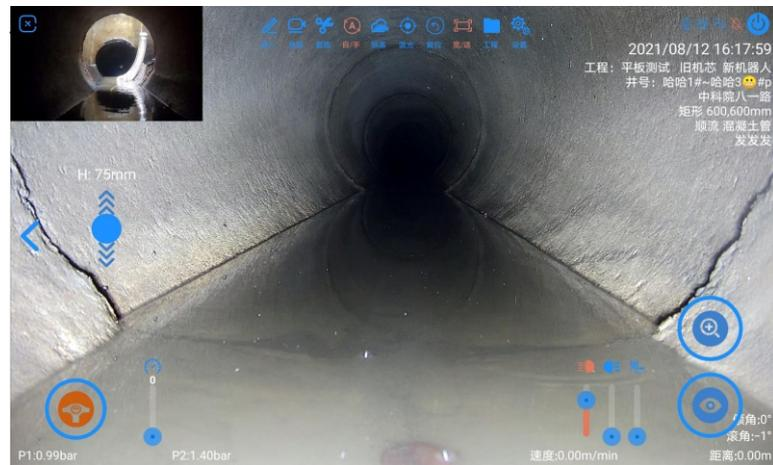
机器人进入管道后，即可点击录像，输入合适参数，调整合适的灯光、镜头角度和速度后，用手柄或者鼠标键盘控制车体前进，观察管道内缺陷，并做好记录。管道测试完成后，点击结束录像，切换画面，打开后视灯，开始回退，到井口后，下吊钩将车体勾起，注意不要磕碰。（附：测试中遇到水深、起雾、堵塞、砖块等情况，不易强行通过，需回收车体，进行预处理后再进行检测）
