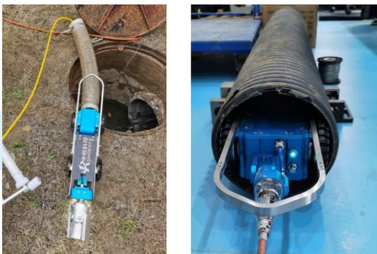
旋转镜头安装在车体接头处，安装4寸轮胎可检200mm管径管道
