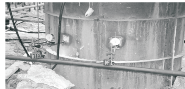
位移表基准梁的架设
