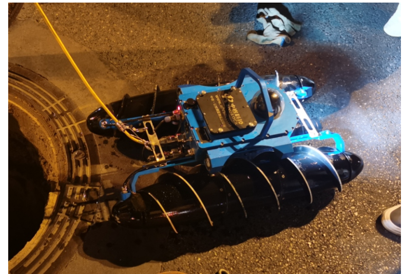
线缆与全地形检测机器人连接
