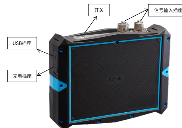
图2-2 RSM-PRT (P) 基桩低应变检测仪各接口示意图
