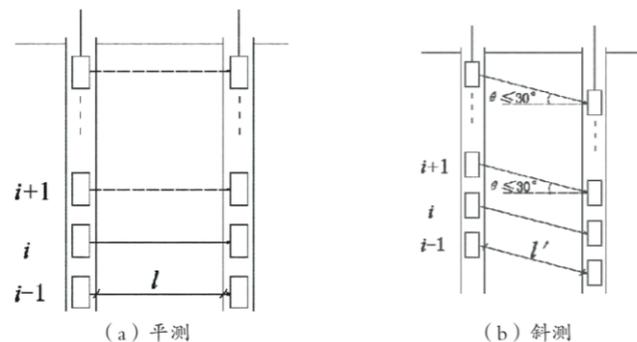
图10.4.2 平测、斜测示意图
