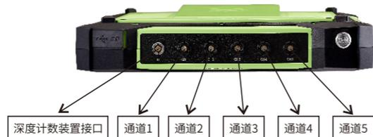
图2-2 RSM-SY7(E)基桩多跨孔超声波自动循测仪前侧面
