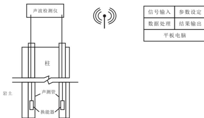
图3-1 基桩声波透射法现场检测示意图
