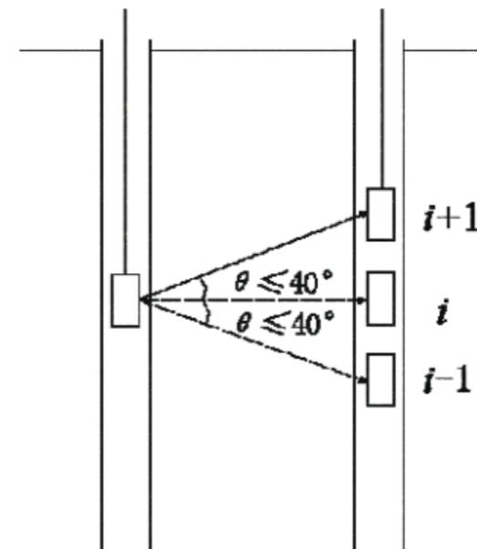
图10.4.2 平测、斜测示意图
