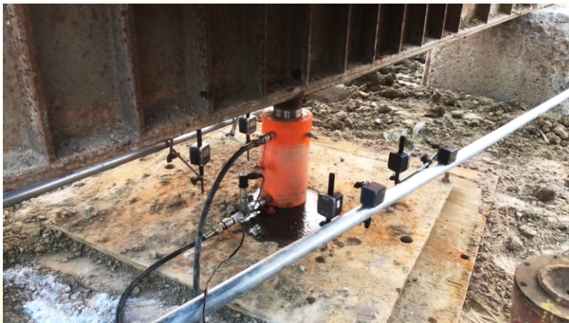
图1 位移及压力传感器安装图
