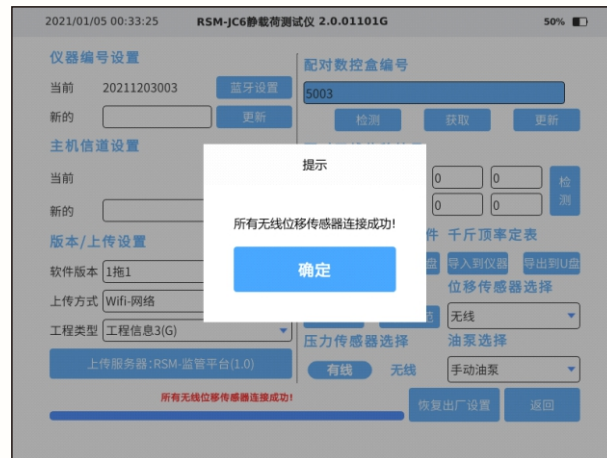
图4 系统设置-位移传感器录入配对连接图
