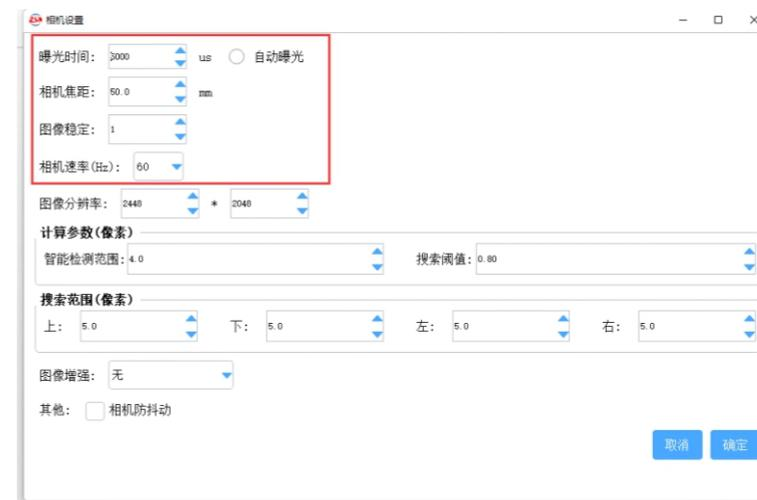
① **曝光时间**：数值默认为5000，当调整镜头上的光圈无法满足图像的明亮调节时，可通过调整曝光时间达到目的。
