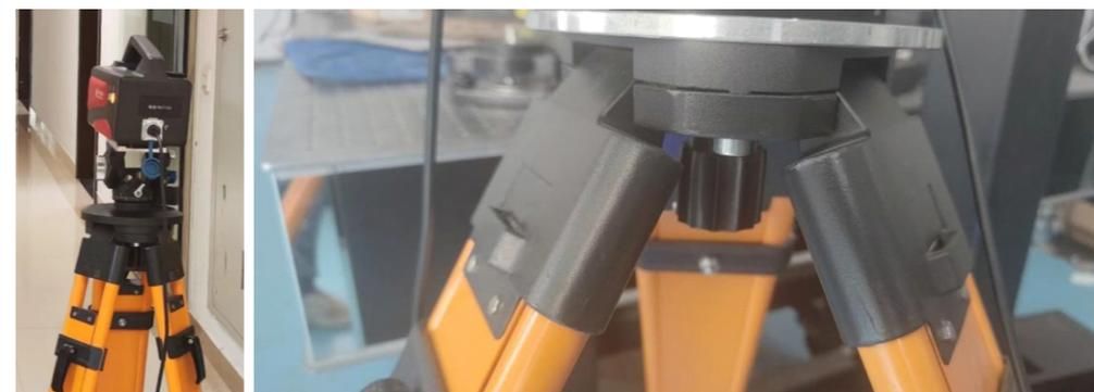
(3) 卸下仪器端镜头盖，安装镜头。
