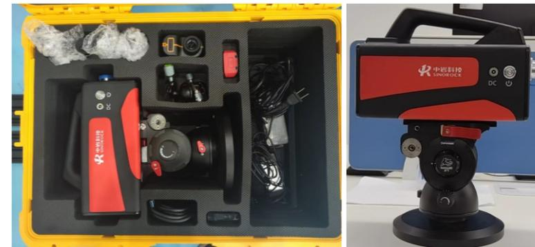
(2) 架设三角架，安装仪器，紧固三角上的螺丝。
