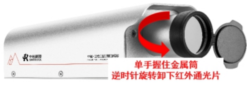
红外通过片拆卸示意图
