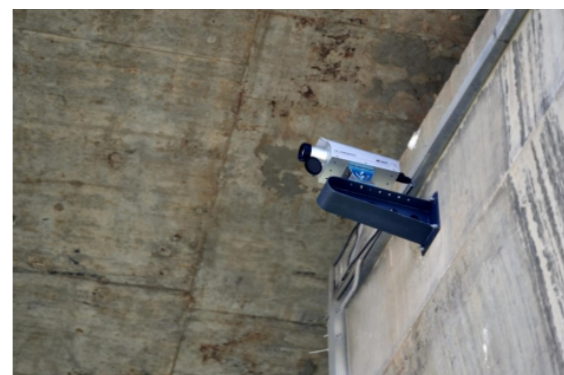
数字图像测量仪现场安装示意图
